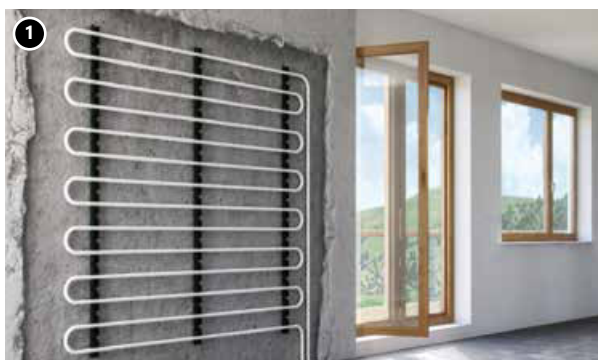
1. Stěnové vytápění/chlazení - konstrukce typu A. 2. Stěnové vytápění/chlazení - konstrukce typu B.
