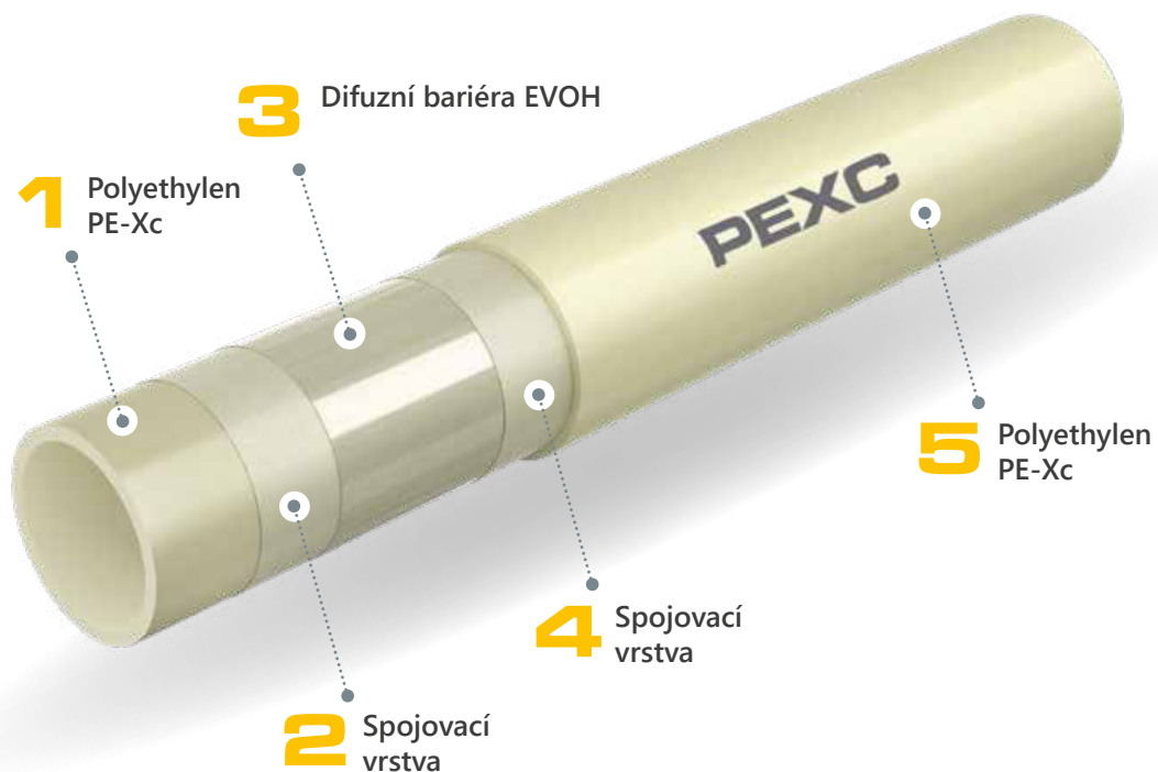
Řez trubkou PEXC s kyslíkovou bariérou
