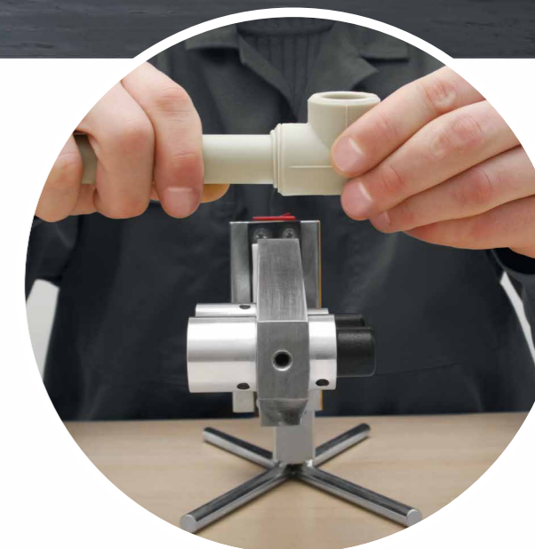
06 Spojování a chlazení spojů.
