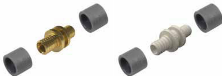
Obr. 50. Spojka KAN-therm ultraLINE k trubkám PEXC, PERT 2 a PERTAL 2 o průměrech 14 × 2, 16 × 2,2, 20 × 2,8, 25 × 2,5 mm.
