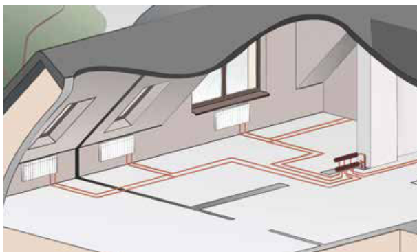
Rozvod otopné soustavy s rozdělovačem a větvemi
