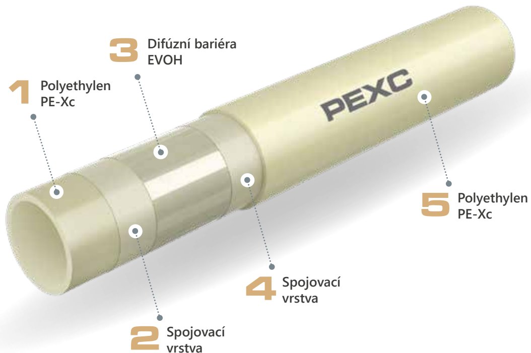
Řez trubkou PEXC s kyslíkovou bariérou
