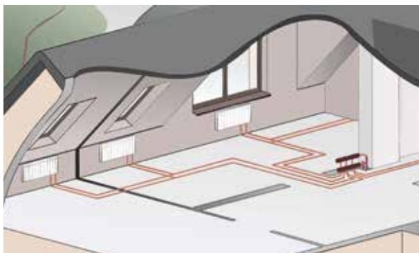
Rozvod otopné soustavy s rozdělovačem a větvemi
