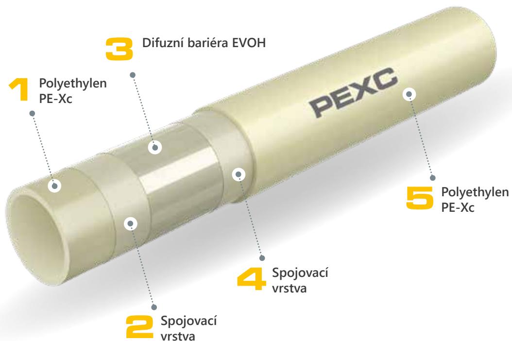
Řez trubkou PEXC s kyslíkovou bariérou
