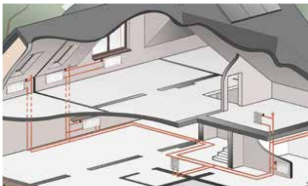
„Stoupačkový“ rozvod otopné soustavy
